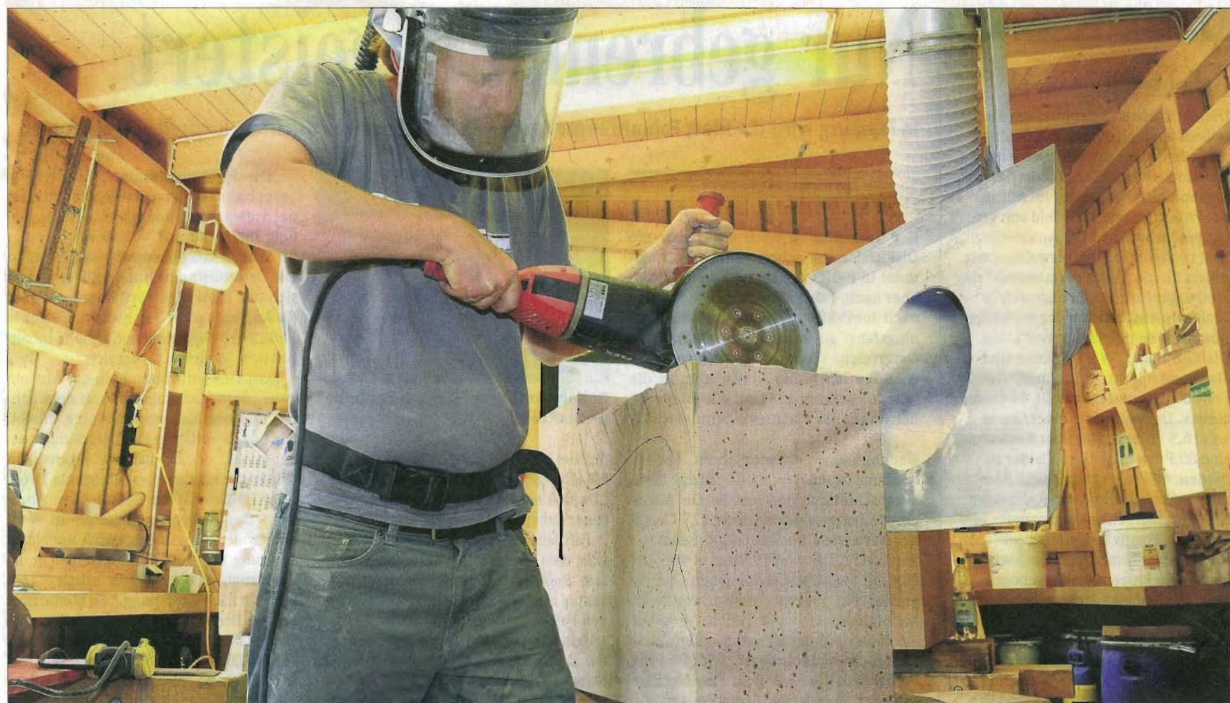
Mit der Flex setzt Till Borsdorf Schnitte in die Oberkante des Rohblocks...
