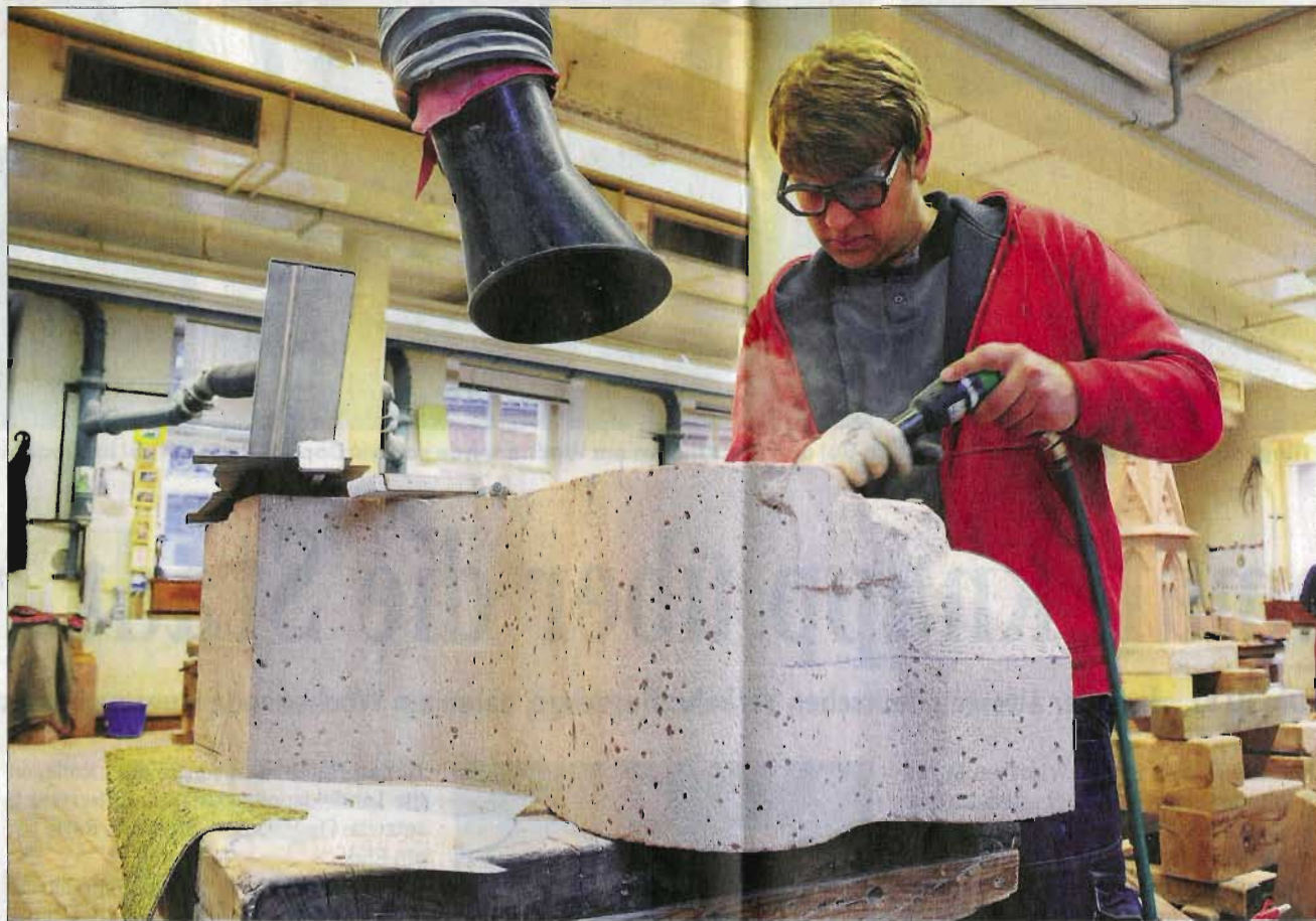
Die linke Flanke zuerst: Mit Eisen und Pressluft bearbeitet Florian Prussait den Sandstein – und der Staub wird abgesaugt.
