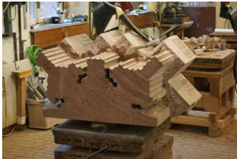
Abb. 48 Die Form des Bauteils (Pos. 5.1b) wird anschließend aus dem Block herausgelöst. Foto 04.08.2022.
