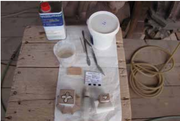
Abb. 79 Klebproben mit dem Steinsilikatkleber. Foto 04.07.2022.
