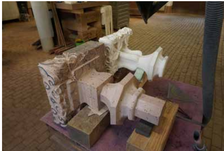
Abb. 30 Die erste der beiden Kreuzblumen für die Vorderseite der Pfeileraufsatzbedachung (Pos.1.3) neben dem Gipsmodell. Foto 24.11.2022.
