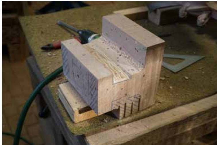
Abb. 43 Eine der zu den kleinen Fialen gehörigen Kreuzblume (Pos. 4.2f) während der Fertigung. Foto 13.01.2022.
