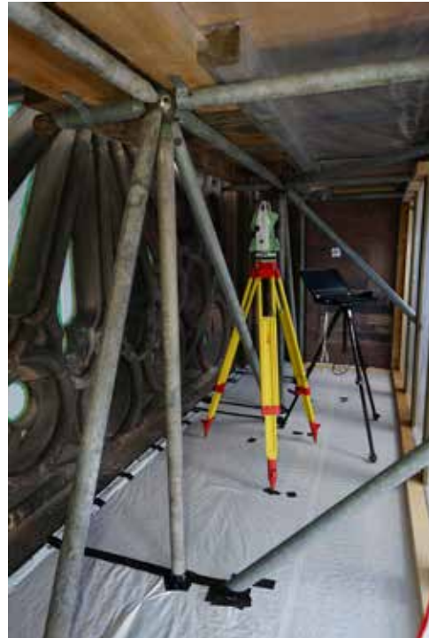
Abb. 95 Arbeitsfoto. Nachmessen mit den Tachymeter auf dem Gerüst. Foto 26.07.2022.
