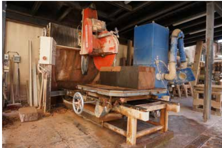
Abb. 33 Mit der Brückensäge werden die Krabbenreihen bis zum Fialschaft vorgesägt. Foto 23.03.2022.
