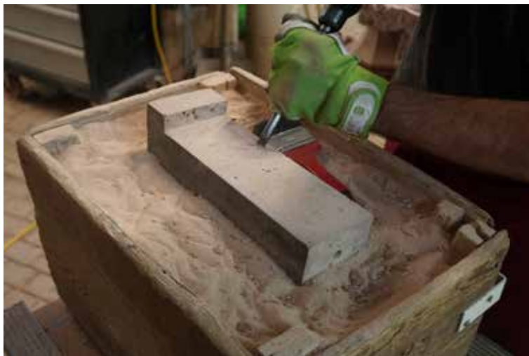
Abb. 46 Einer der vier zu fertigenden Knäufe der Kreuzblumen (Pos. 5.1a) in Fertigung. Foto 23.05.2022.
