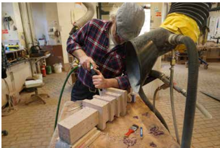
Abb. 41 Eine kleine Fiale (Pos. 4.1g) während der Fertigung durch den Steinmetzen Tamer Demirel. Foto 01.03.2022.
