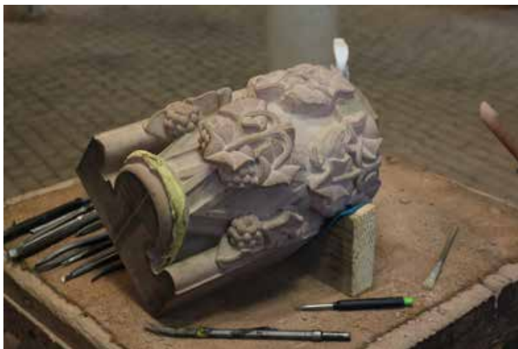
Abb. 36 Das Blattkapitell (Pos. 3.5a) während der Fertigung. Foto 21.06.2022.
