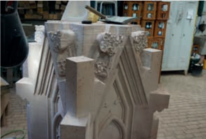
Abb. 6: Der Übergang vom oberen quadratischen Fialenbereich zum Helmspitz. Hier beginnt auch der Übergang zu den Distelformen, die hier nachweislich am Wimperg als erhaltenes Fragment rekonstruierbar waren, 09.11.2023 (MBV, A. Schedlbauer)
