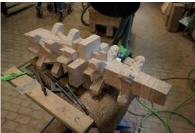
Abb. 20: Die erste der vier Fialen am oberen quadratischen Fialenbereich. Hier wurde die selbstentwickelte Krabbenform der Fialenbekrönung vom polygonalen Fialenbereich übernommen, 24.07.2023 (MBV, A. Schedlbauer)
