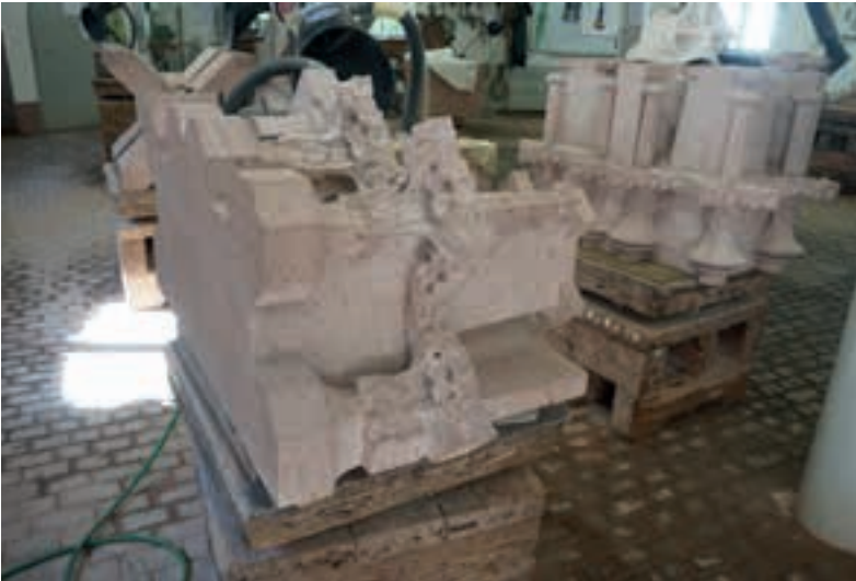
Abb. 16: Die zweite Hälfte des Übergangsbereiches zum quadratischen Fialenbereich ist ebenfalls schon weit fortgeschritten. Diese beiden Werkstücke sind die aufwändigsten am ganzen Pfeileraufsatz, 06.09.2023 (MBV, A. Schedlbauer)
