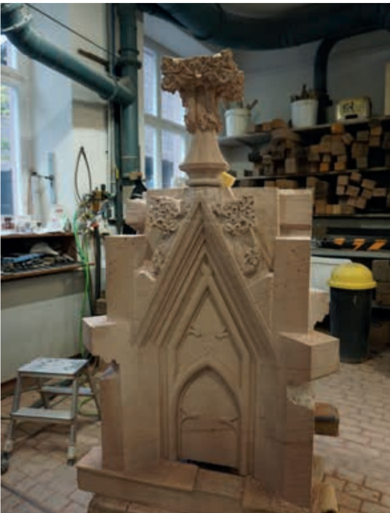
Abb. 7: Fertige distelförmige Kreuzblume auf dem Wimperg, 02.11.2023 (MBV, A. Schedlbauer)
