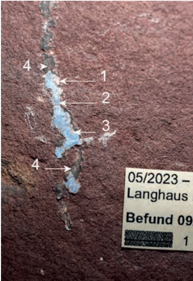
Abb. 64: 1 = Weiß, Kalkanstrich, dickschichtig; Grundierung, partiell evt. Sichtfassung. 2 = Blau, Fassung, zweischichtig; Zusammensetzung: Bleiweiß, Ultramarin und Zinnober; Bindemittel ist trocknendes Öl. 3 = Rosa-Hellgrau. Umwandlungsschicht des im Blau enthaltenen Bleiweißes, vermutlich mit Partikeln des Zinnobers. 4 = Bräunlich-Schwarz = dünn-schichtig; verschwärztes Bleiweiß und Schmutz. 18.09.2023 (J. Quatmann)
