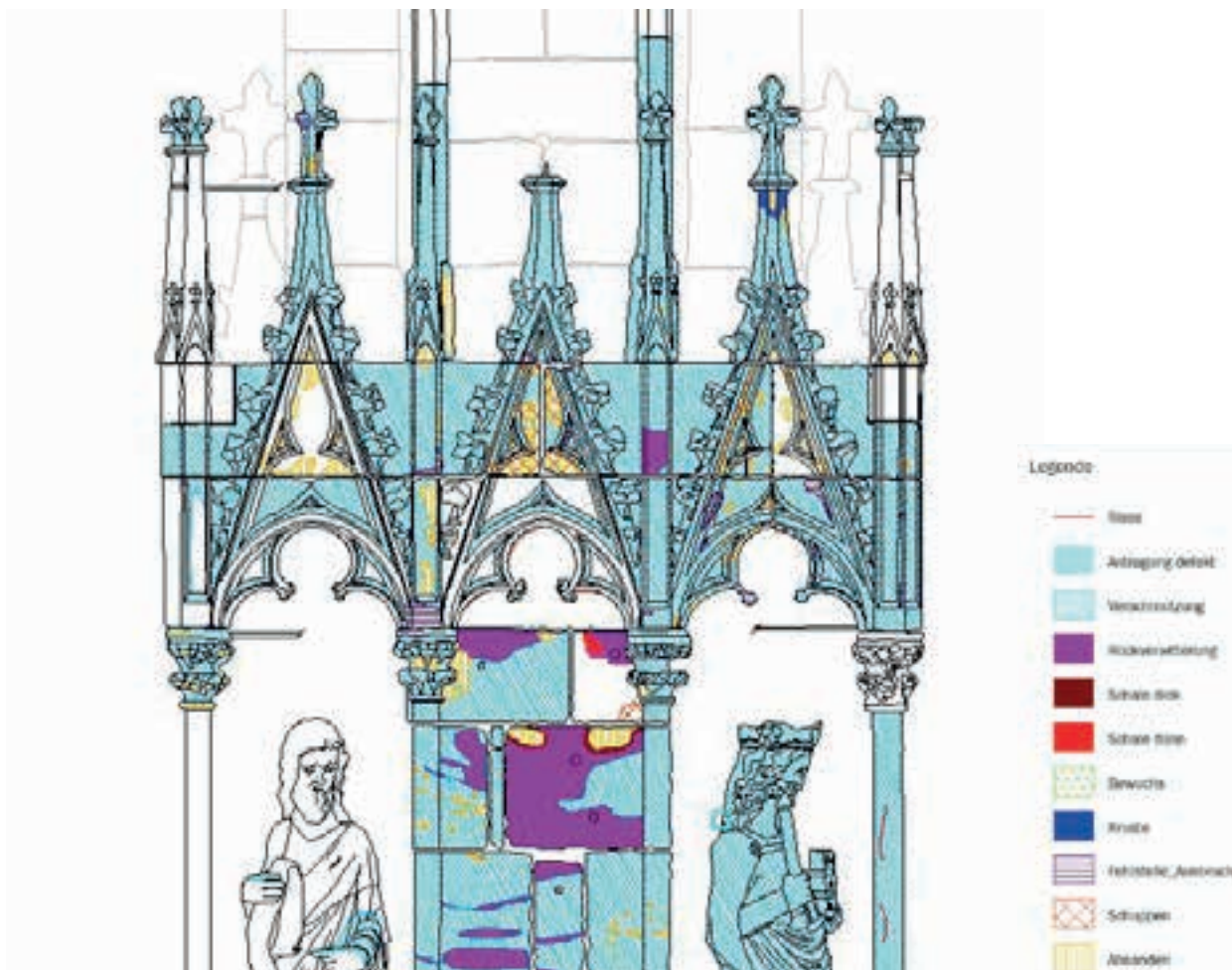
Abb. 85: Auszug aus der vorläufigen Schadenskartierung des nordwestlichen Dreikantpfeilers (Andreas Schedlbauer, Eva Höglauer)
