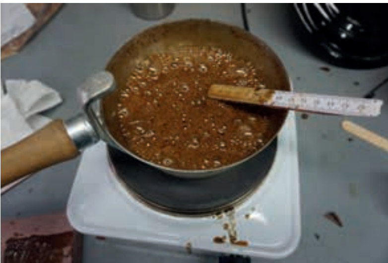
Abb. 34: Langsames Aufkochen der Klebermischung in einer Metallschöpfkelle, 04.05.2023 (MBV, U. Zäh)
