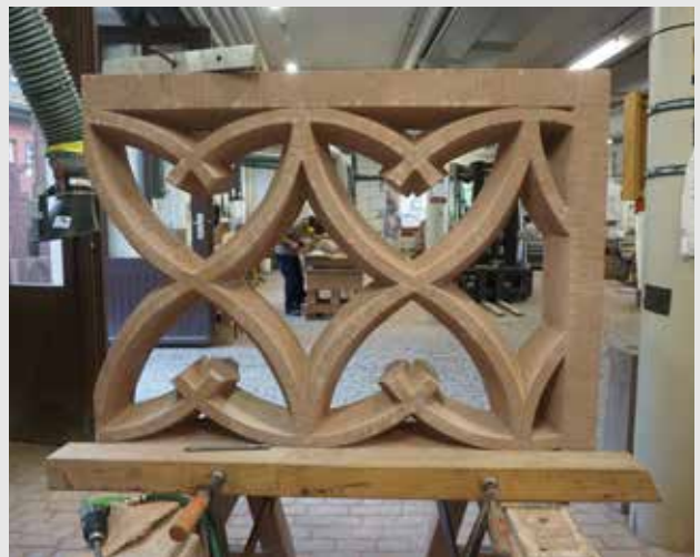
► Abb. 19: Eins von drei fertigen Brüstungsteilen für die Nördliche Kaiserkapelle (04.03.2025).
