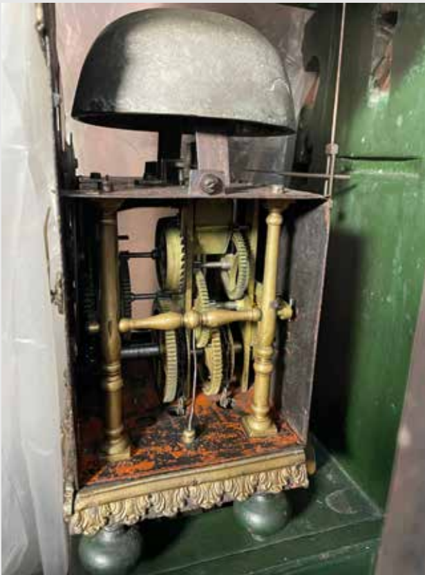
► Abb. 8: Die metallene Stuhlluhr sitzt auf der grüngelassenen Holzkonsole. Sie ist seitlich geöffnet, so dass das Uhrwerk mit der darauf befindlichen Schlagglocke einsehbar ist.
