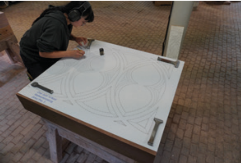
Abb. 2: Aufreißen der Durchbrüche und Profile 21.08.2025 (MBV, A. Schedlbauer)
