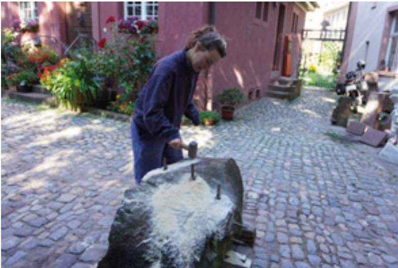
Abb. 1: Elsa Scharpf an ihrem ersten Arbeitstag beim Abkeilen eines Sandsteinfelsens aus Leistadt 25.08.2025 (MBV, A. Schedlbauer)
