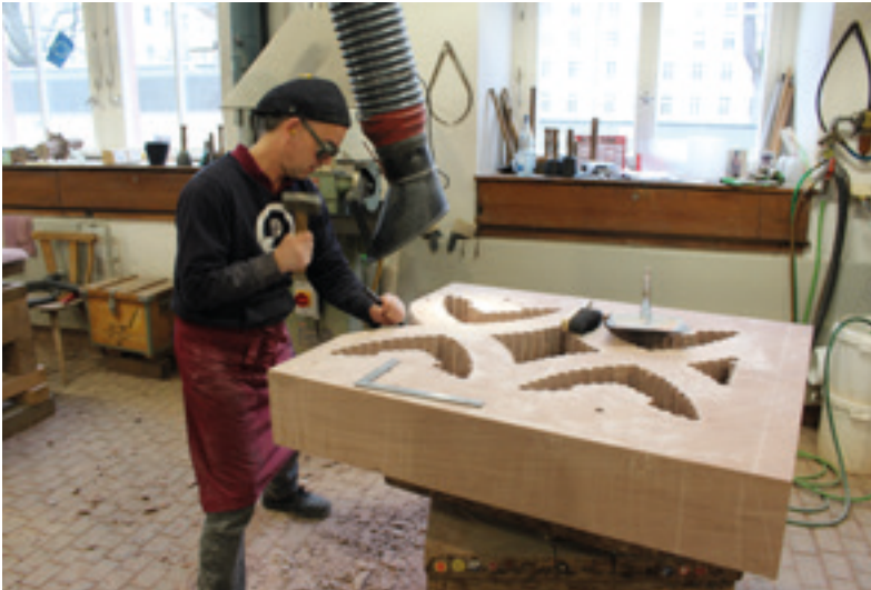
Abb. 2: Das linke der drei neuen Werkstücke nach dem Vorbohren mit einem Diamant-Kernbohrer 04.02.2025 (MBV, A. Schedlbauer)
