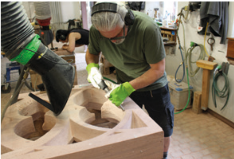
Abb. 3: Ausarbeiten der Profile beim rechten Maßwerkteil 21.07.2025 (MBV, A. Schedlbauer)
