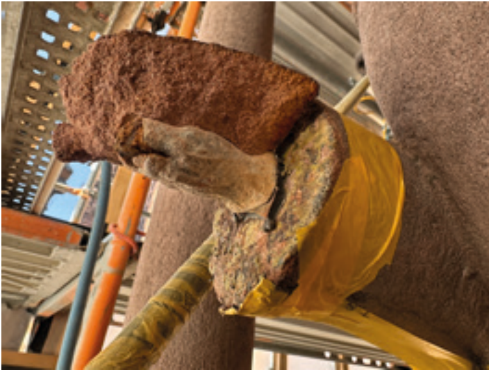
Abb. 4: zeigt das rechte Vorderbei des Pferdes. Die Korrosion an den Eisenverbindungen und die daraus resultierenden Folgeschäden sind zu erkennen. 07.03.2025 (L. Kürten)
