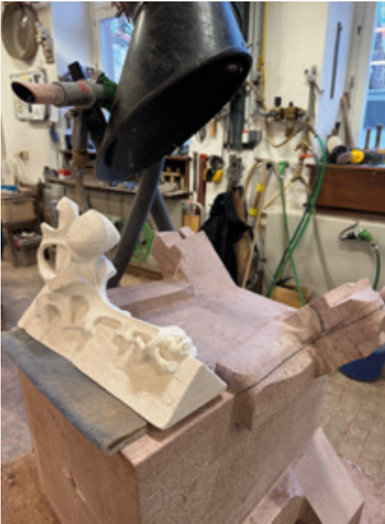
Abb. 17: Gipsabguss einer Krabbe als Vorlage für die freie Übertagung in Stein 19.11.2025 (MBV, A. Schedlbauer)
