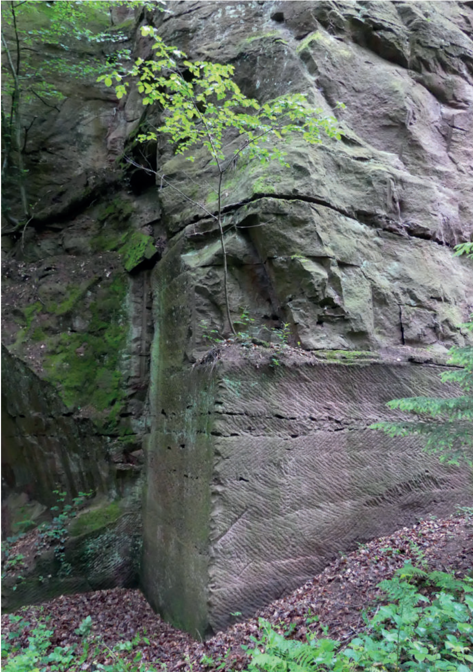
Abb. A16: Abbauwand im Großen bzw. Oberen Steinbruch. Über einem ca. 4 m hohen Abschnitt mit historischen Abbauspuren (18./19. Jh.) erhebt sich eine ca. 15 m hohe, unregelmäßige Wand, die auf Sprengarbeit zurückgeht.
